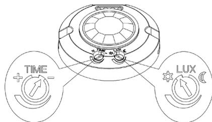
*Quando ensaiado durante o dia, rodar o botão "LUX" para a posição "☀" (sol), caso contrário, o sensor não funciona!*
