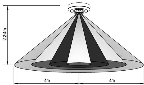
ALTURA PARA INSTALAÇÃO: ENTRE 2,2 E 4m
