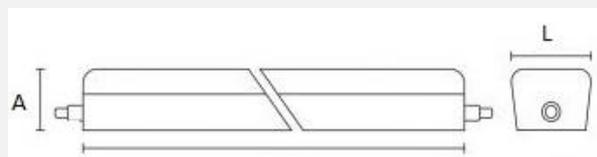
Este modelo contém 1 módulo LED de 36W e 2 conectores rápidos para uma instalação simples e rápida.
